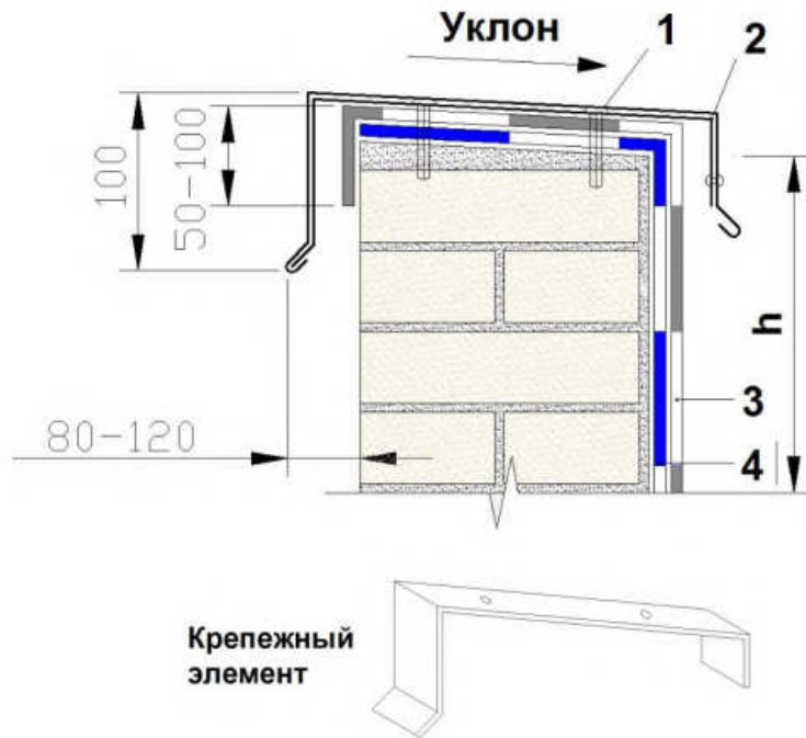
Мал. 16. Примикання до парапетної стіни висотою h менше 500 мм за допомогою фартуха.
